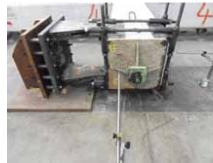
Foto 3: Cerniera inferiore con piastra di precompressione
