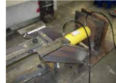
Foto 2: martinetto a doppia azione in sommità pilastro
