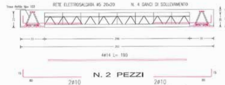
Figura 12: sezione longitudinale solai 1 e 4
