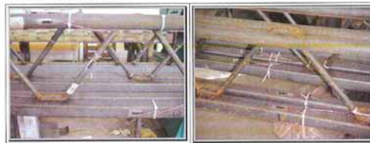
Fig. 13 Strain gages saldati alle barre dei tralicci prima del getto di calcestruzzo.
