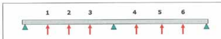
Fig. 11. Posizione e numerazione dei trasduttori di spostamento
