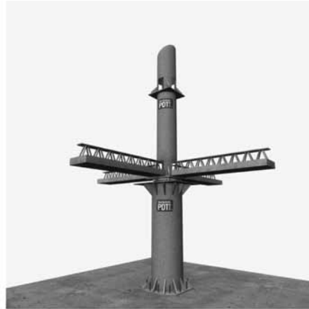
Fase 2 Posa delle Travi REP® al primo livello – al di sopra dell'isolatore – e dell'armatura aggiuntiva al nodo.
