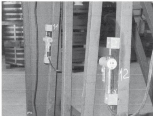
Foto 06 : Sensori di tensione sui montanti esterni ( Ch.11 e Ch.12 ). Prova 831/TV
