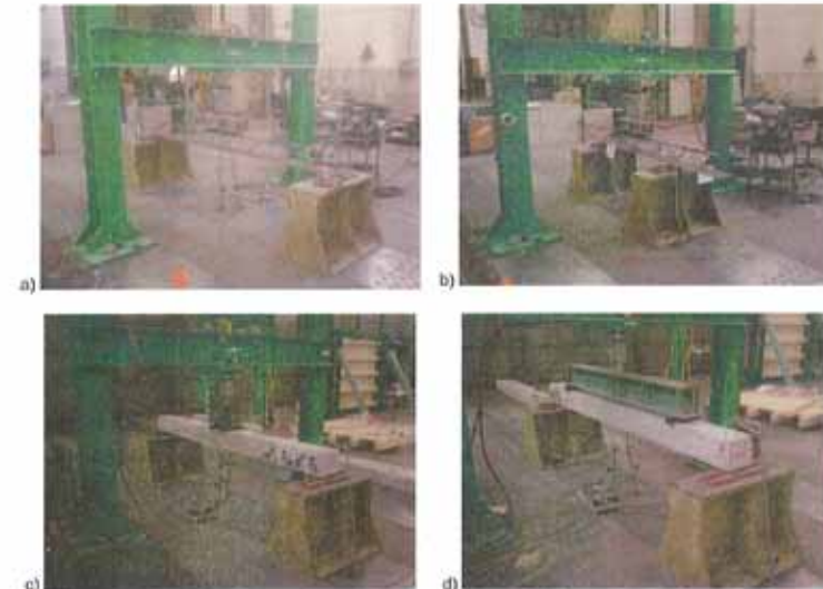
Figura 6: raccolta fotografica delle prove: a) prove a flessione su trave nuda, b) prove a taglio su trave nuda, c) prove a flessione su trave mista, d) prove a taglio su trave mista.
