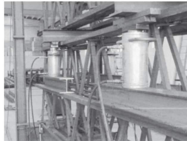
Foto 04 : Martinetti a spinta e putrelle di ripartizione del carico .
