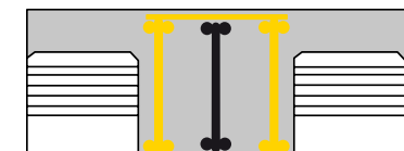
Figura 10: nuova soluzione sezione tipo Trave REP® Nor con connessione REP® TRC (in giallo)
